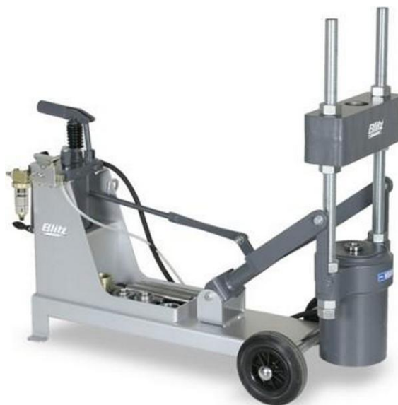
СТЕНД ДЛЯ ВЫПРЕССОВКИ ШКВОРНЕЙ (усилие 40000 кг)
