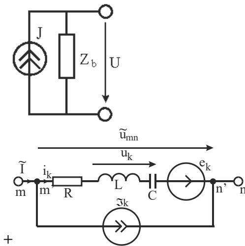
Для указанной схемы уравнение по первому закону Кирхгофа применительно к узлу  $m'$  будет иметь вид:
