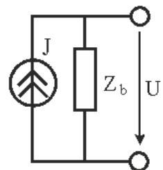
Элемент цепи, создающий заданный ток, напряжение на полюсах которого зависит от цепи, подключенной к нему, это...
