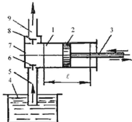
На рисунке изображен поршневой насос простого действия.
