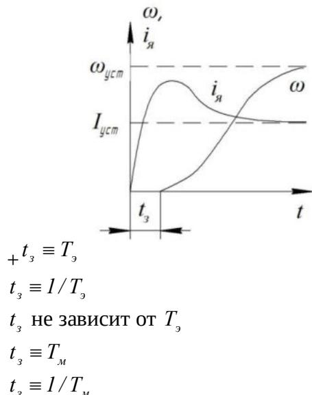
**При увеличении момента сопротивления рабочей машины время пуска для одного и того же двигателя:**
