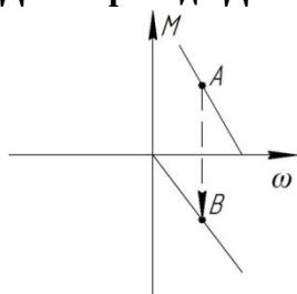
+отключить обмотку якоря от сети и замкнуть её на дополнительное сопротивление, оставив обмотку возбуждения под напряжением
