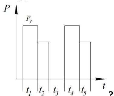
$$\epsilon = \frac{t_1 + t_2 + t_3}{t_1 + t_2 + t_3 + t_4 + t_5}$$
