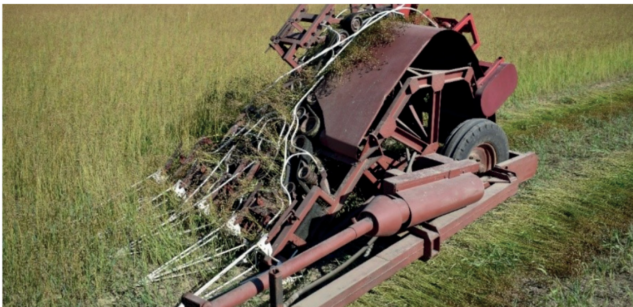
Теребилка-плющилка льна ТЛП-1.5К(П) в работе, вид спереди
