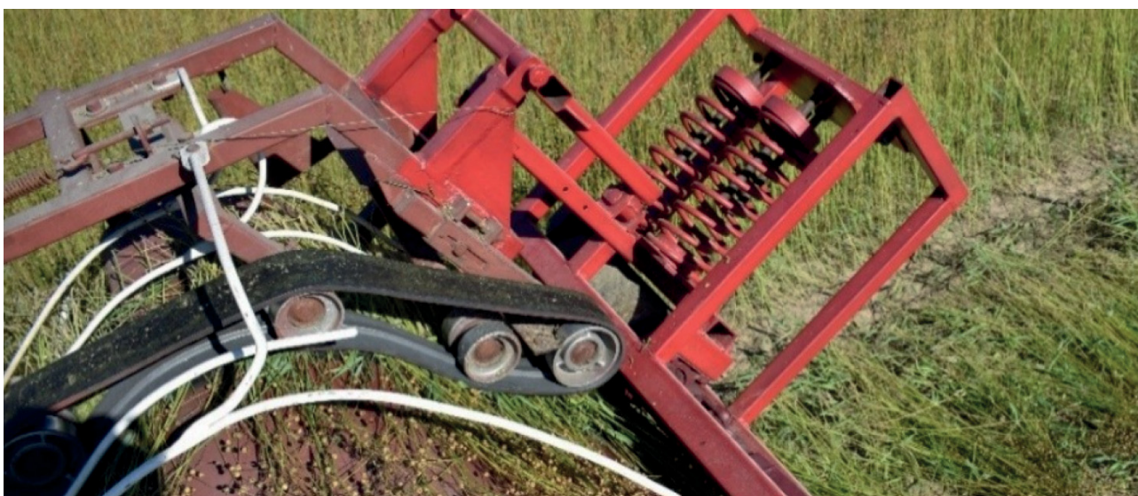
Плющильный аппарат в работе
