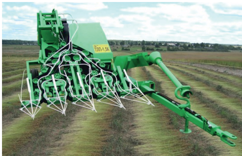
Прицепная прямоточная теребилка льна ТЛП-1,5К
