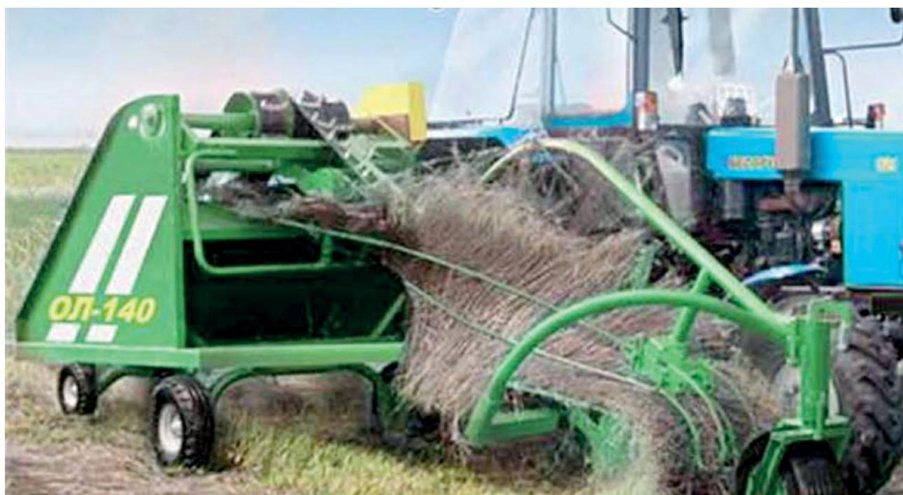
*Рисунок 1 – Подборщик-оборачиватель ОЛ-140*
