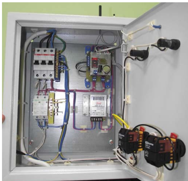
Рисунок 4 — Шкаф системы удаленного управления приемниками электрической энергии с контролем текущих параметров технологического процесса в сборе
