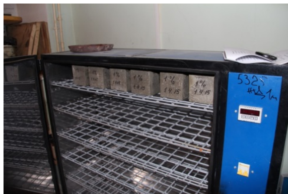
Рисунок 2 — Маркировка готовых образцов фибробетона и закладка их в камеру нормального твердения
