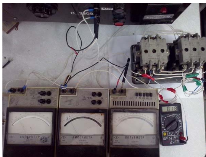
Рисунок 2 — Опытные исследования нагрева катушек
