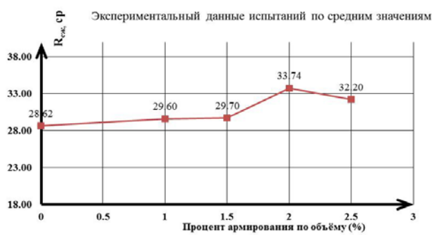
Рисунок 4 — Зависимость расчетного сопротивления сжатию от процентного содержания фибры: а — по средним значениям; б — по максимальным значениям
