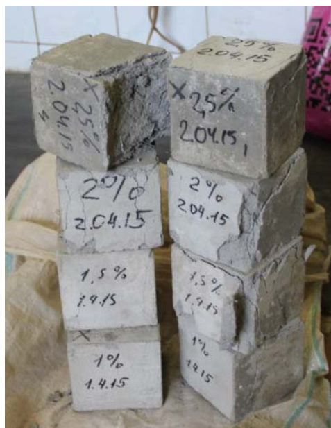
Рисунок 5 — Характер разрушения образцов с различным процентным содержанием фибры по объёму
