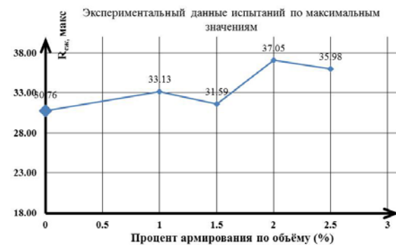
Рисунок 4 — Зависимость расчетного сопротивления сжатию от процентного содержания фибры: а — по средним значениям; б — по максимальным значениям
